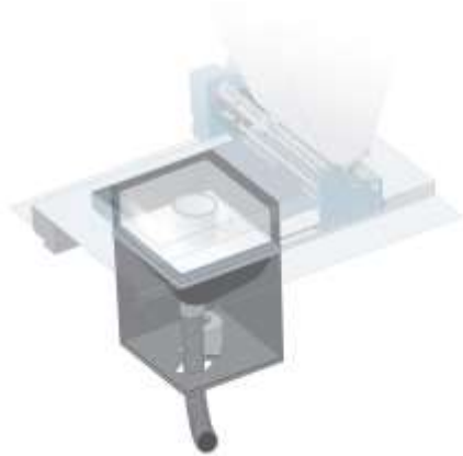
Figura 16 Dopo ogni strato il pistone si abbassa.
