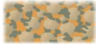
Figura 19 La matrice aperta consente l'inserimento di un grande quantità di infiltrante nella parte.
