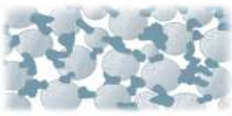
Figura 21 Il collante solidifica la polvere.
