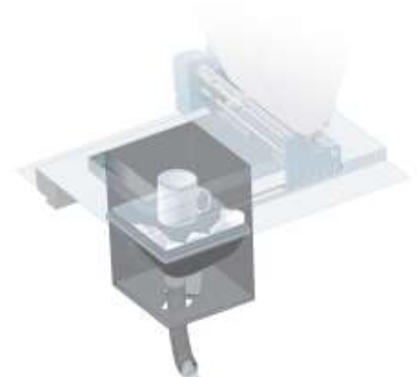
Figura 17 Alla fine il modello rimane all'interno per l'indurimento. Alla fine del processo la maggior parte della polvere viene aspirata.
